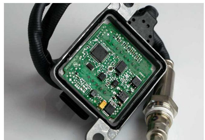
**Figura 3.** Placa de circuito del sensor.
