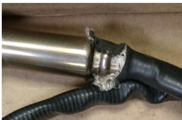
**Figura 14.** Evidencia de cableado dañado.
