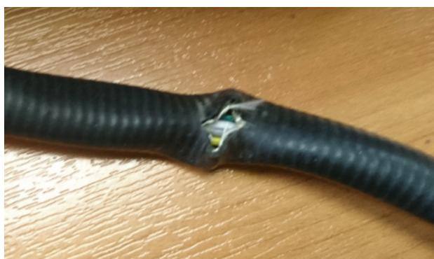
**Figura 13.** Figura 13. Protector de cable dañado.
