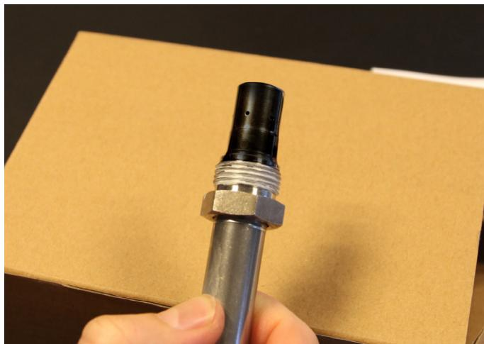
**Figura 12.** Figura 12. Evidencia de hollín / ceniza excesivos.
