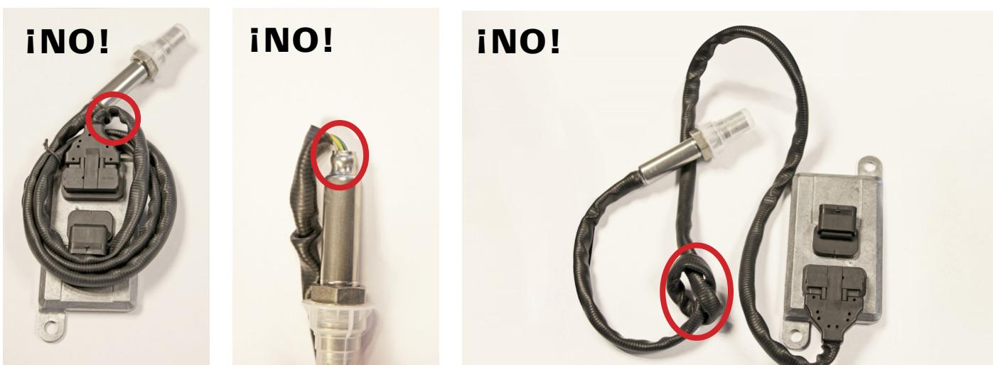
**Figura 5.** Manejo inadecuado del cable.
